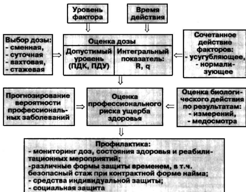
Рис.1. Схема оценки и управления профессиональным риском ущерба здоровью при контакте с повышенными уровнями ведущих вредных факторов производственной среды (пыль, шум и вибрация).
